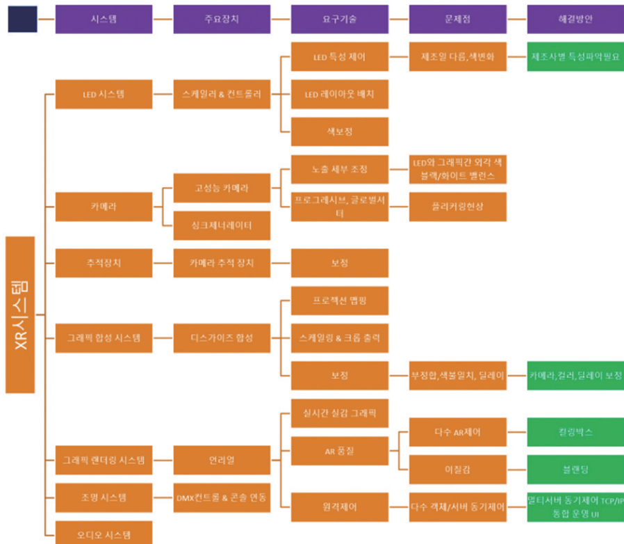
그림 9 시스템, 주요장치, 요구기술, 문제점, 해결방안
